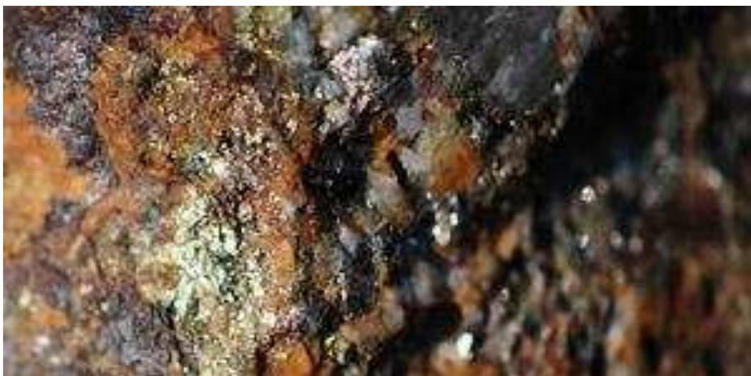
Foto von der Erzprobe mit einem Edelmetallgehalt von etwas mehr als 85 g/t Gold
